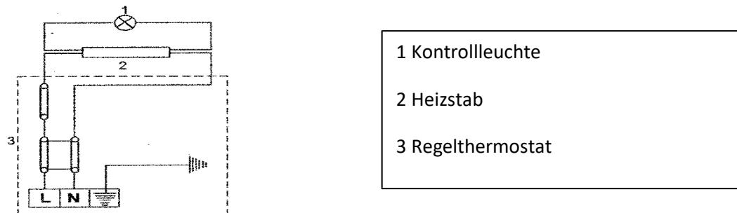
Dieser Speicher ist ein modernes Modell, welches eine einfache Handhabung ermöglicht. Das Thermostat besteht aus einem Regulierungsthermostat mit einem integrierten Schutzthermostat.
